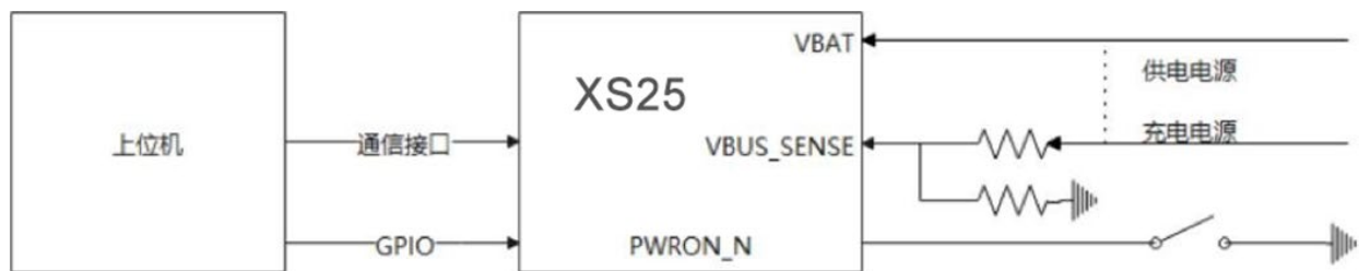
图 3.1 模组上电引脚连接参考图
